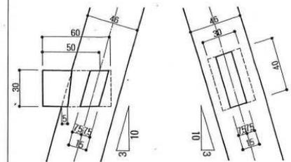
側面図によるA,B,C貫詳細図
